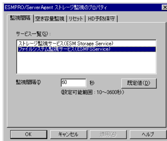
図 47 ESMPRO/ServerAgent のコントロールパネル [ストレージ監視]-[監視間隔]タブ
