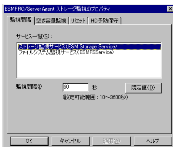
図 50 ESMPRO/ServerAgent のコントロールパネル[ストレージ監視]-[監視間隔]タブ
