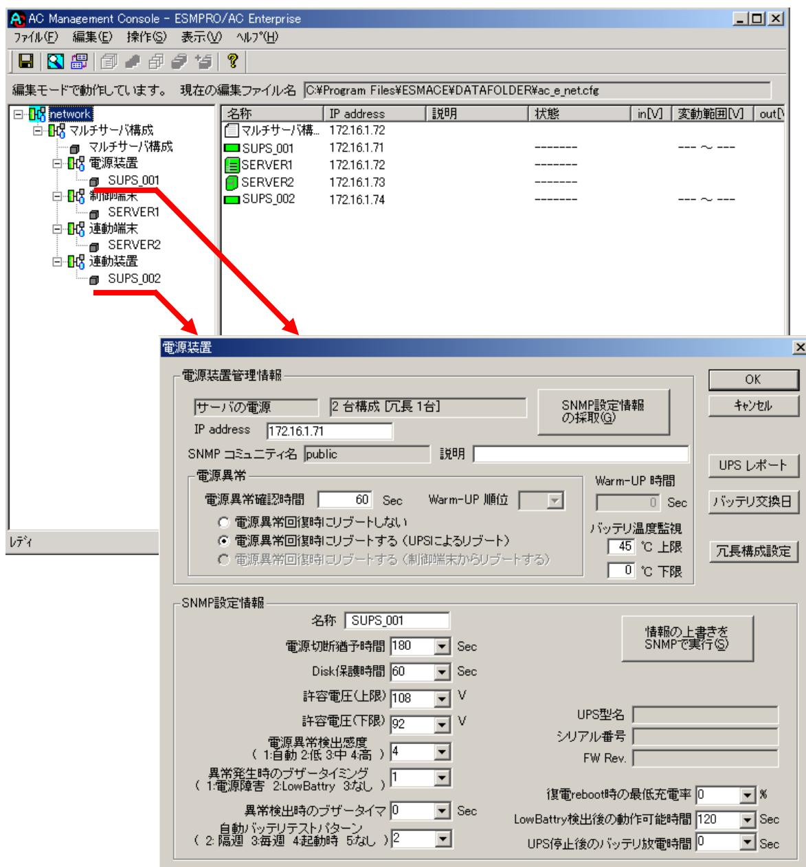
マルチサーバ構成データ編集ツールで操作を行っているWindows端末に、SNMPがインストールされているか否かで、本メニューの変更内容をUPS装置に反映する手順が異なります。次の手順を参照の上、設定内容をUPS装置に反映させてください。
