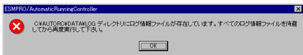
上記のエラーメッセージが表示された場合、すでにログファイルが存在することが考えられます。ログ採取に失敗した連動端末のESMPRO/AutomaticRunningControllerインストールディレクトリ下のDATA¥LOG下にログファイルが存在する場合は、ファイルを退避するか削除して、操作をやり直してください。
