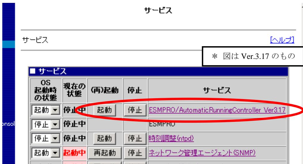
③インストール直後にはサービスの状態は停止となっています。ESMPRO/AC for Linuxをインストールした制御端末の環境設定が完了してから、必要に応じて「起動」でサービスを起動してください。
