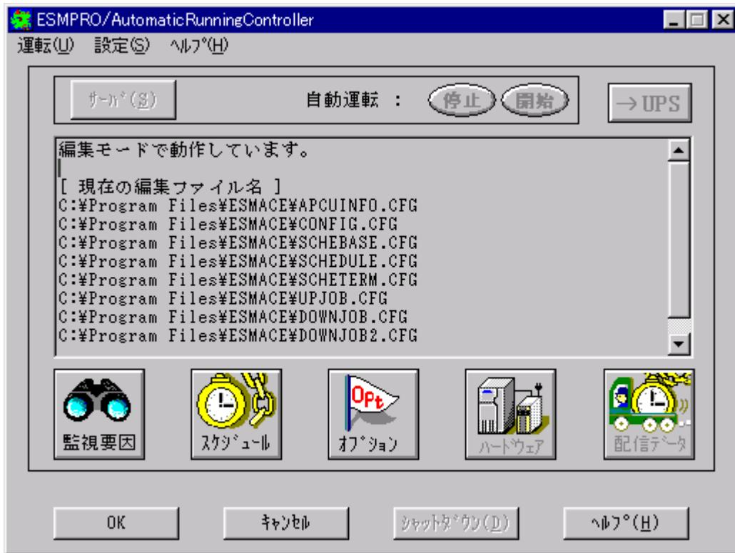
この「ESMPRO/AutomaticRunningController GUI」では、Linux制御端末が制御するマルチサーバ構成のLinux制御端末側の自動運転情報を設定します。
