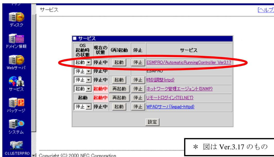
(2) 以下の画面で「新しいウィンドウで表示」を選択して「AMC」を呼び出してください。
