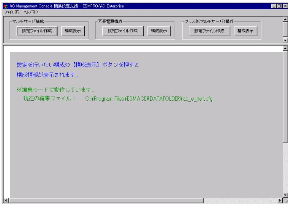
この「AC Management Console 簡易設定支援ツール」は、AMC機能によるマルチサーバ電源管理構成の基本的な環境を設定するためのツールです。本ツールを利用して、マルチサーバ電源管理構成の基本的な設定を行っておき、「AC Management Console」において、詳細な設定を行ってください。「AC Management Console」のみでも設定は可能ですが、この「AC Management Console 簡易設定支援ツール」で、基礎部分の設定をすることをお勧めします。
