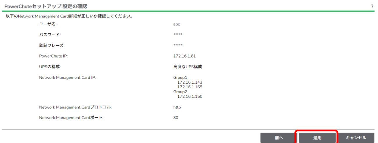
(12) UPSと通信を開始しますので通信が確立されることを確認し、「次へ」を押します。
