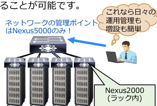
高密度10G集線および40G/100Gアップリンクポートにより、データセンターネットワークの広帯域化を実現。Nexus特有の機能を活用し運用管理を効率化。
