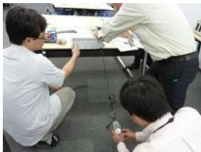
電源コード固定の強度試験
