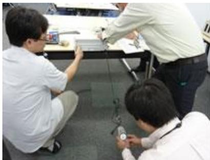
電源コード固定の強度試験
