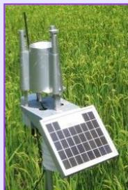
NEC田んぼでは周辺の環境変化をモニタリングするために太陽電池で駆動するセンサーを設置し、温度や水温など7種類のデータを10分単位に測定しています。
