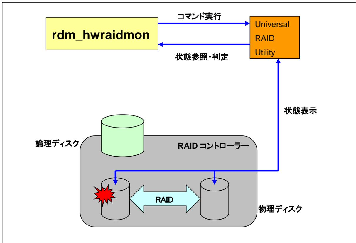
図 1 HW-RAIDSCSI 統計情報監視デーモンによる 物理 OS ディスク監視構造
