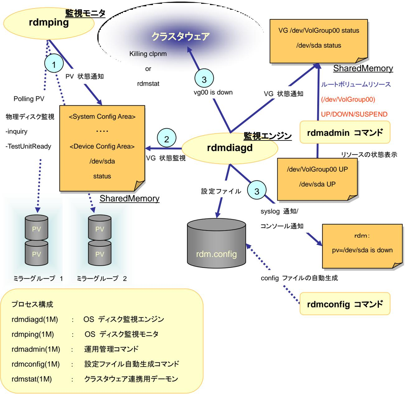
図 2 RootDiskMonitor のプロセスモデル
