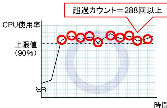
→ CPU 使用率は CPU 使用率上限値 (90%) を超え続け、連続して閾値 (288 回) を超えたため、高 CPU 使用率プロセスと判定する。
