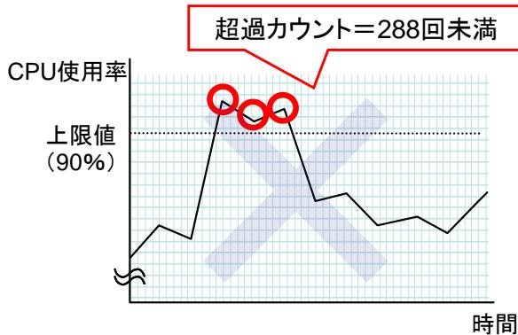
→ 一時的に CPU 使用率上限値を超えるが、その後規定回数 (288 回) を超える前に上限値以下で推移しているため、高 CPU 使用率プロセスとは判定しない。
