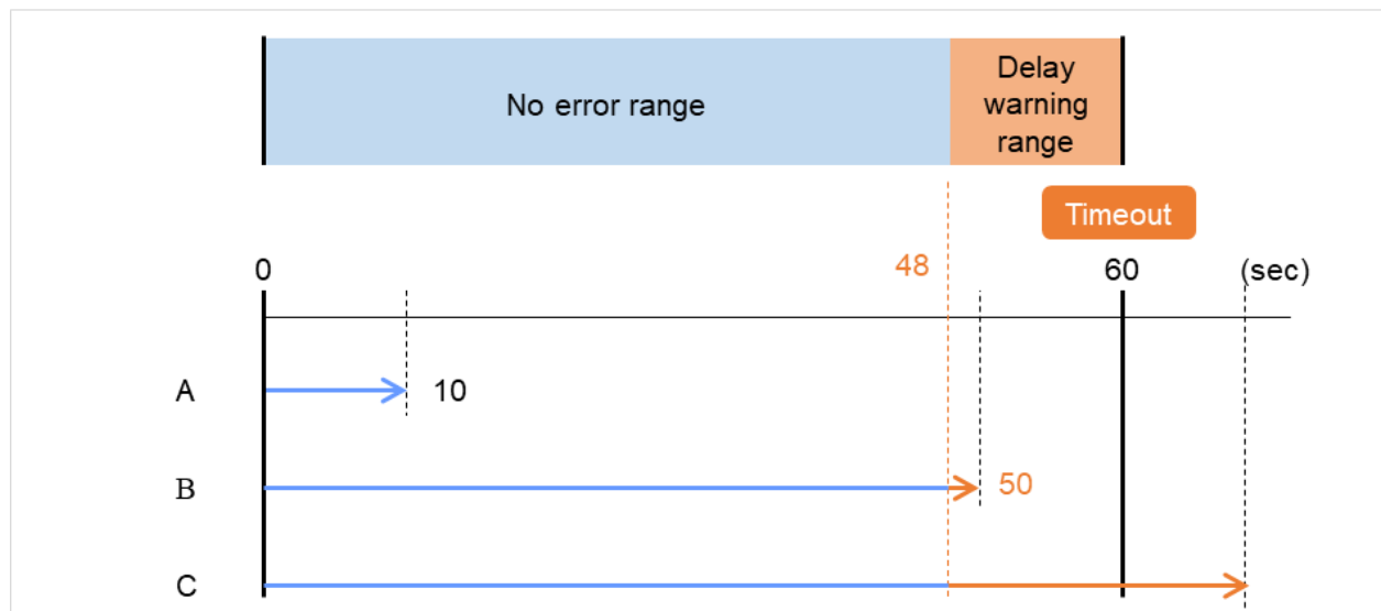
図 4.46 監視ポーリング時間と遅延警告
