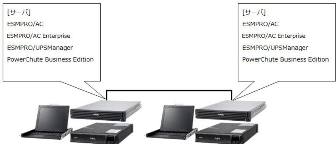
また、共有ディスクがあるクラスタ構成の場合でも、下図のように冗長共有ディスクであり、その電源をクラスタサーバの電源を供給している両方の UPS から供給できるシステム構成であれば、自動運転機能を提供します。
