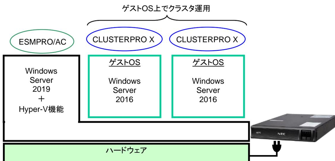
以降の説明を参照し、ホスト OS 上の ESMPRO/AC からクラスタ運用しているゲスト OS に対して、クラスタシャットダウン指示を行うための設定を行ってください。
