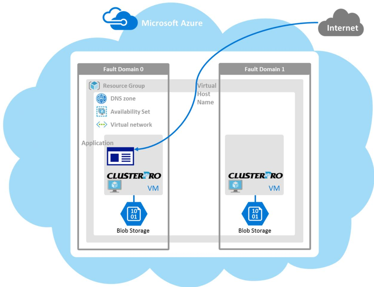
図 2.2 Azure DNS を使用した HA クラスタ
