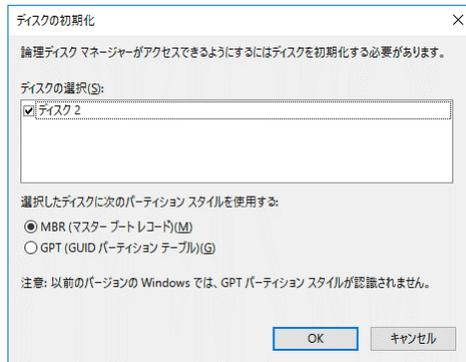
2. 既に存在している C ドライブおよび D ドライブの下に追加ディスクがディスク 2 として未割り当て状態で表示されていることを確認します。
