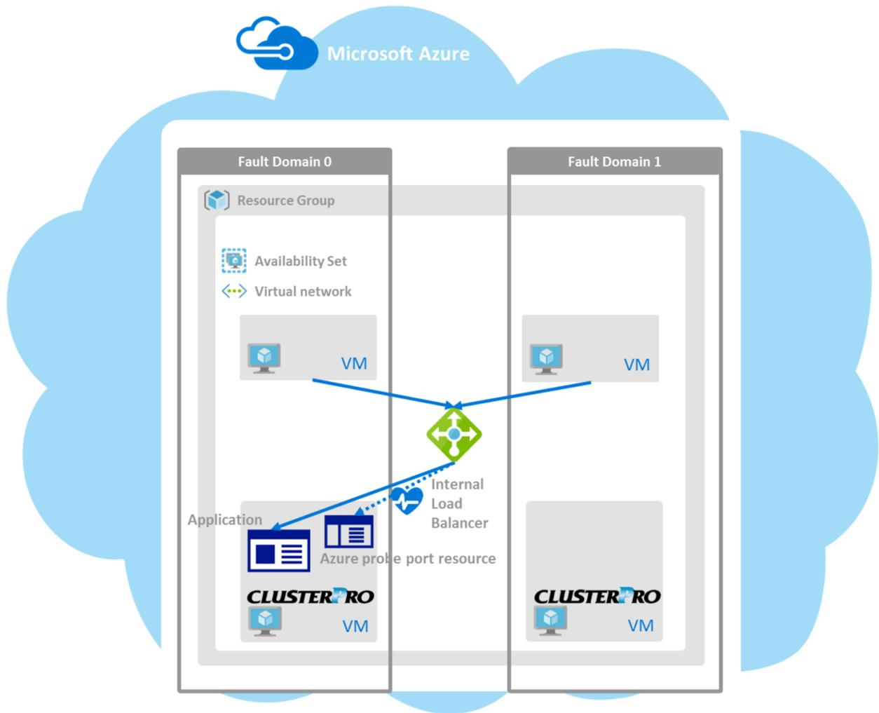
図 2.4 内部ロードバランサーを使用した HA クラスタ
