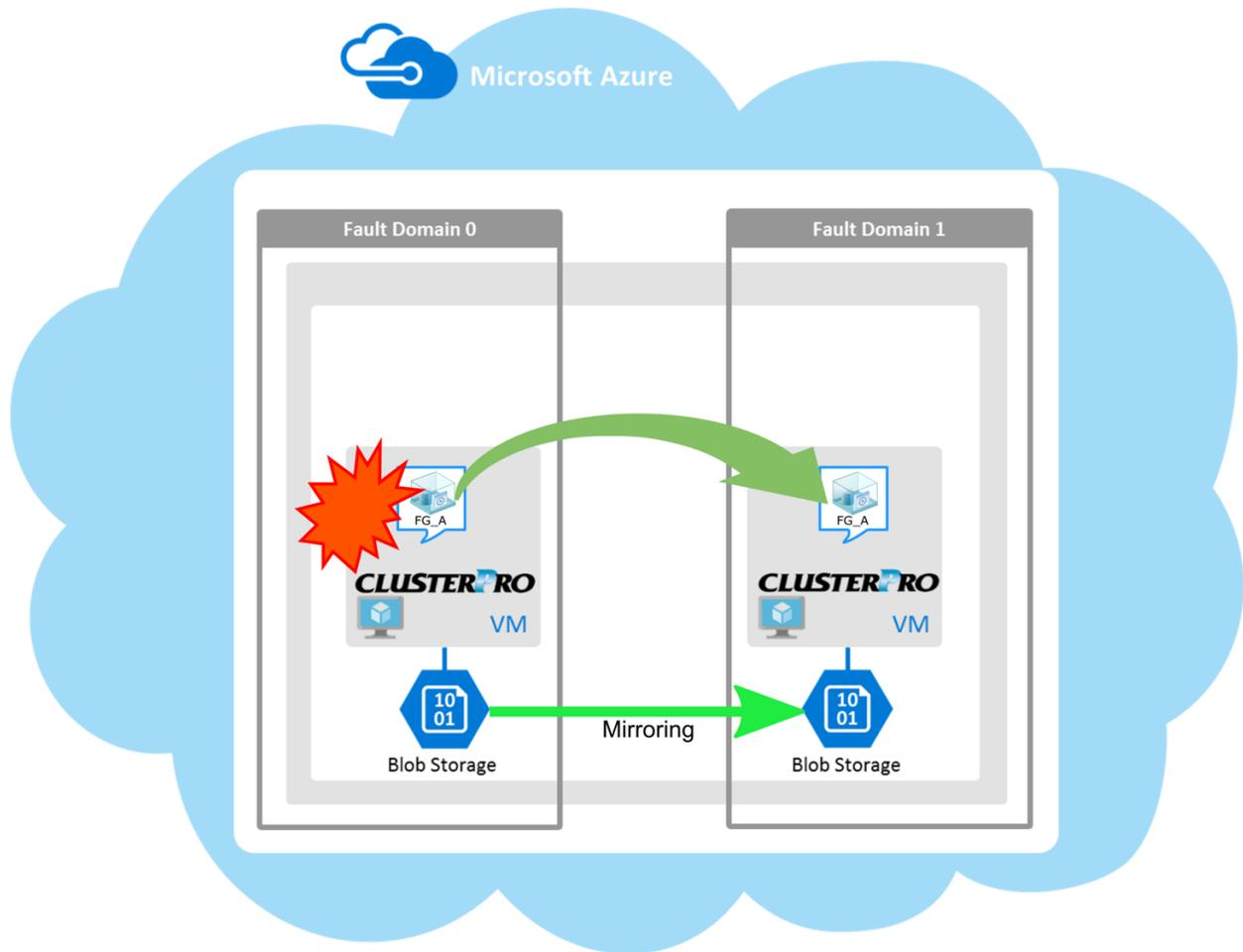
図 2.1 クラウドサービス上の HA クラスタ (Azure DNS を使用した場合)
