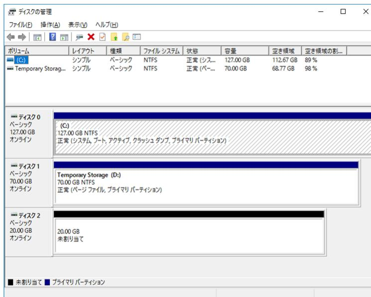
3. クラスタパーティションを作成します。[ディスク 2] 上で右クリックし、[新しいシンプル ボリューム] を選択します。
