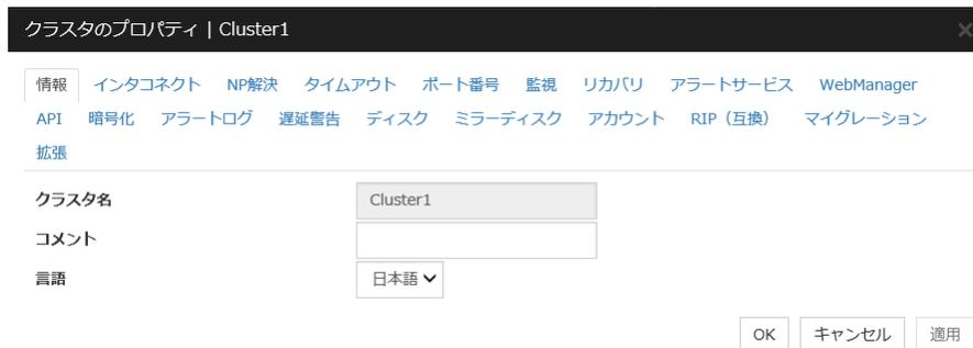
2. [タイムアウト] タブを選択します。ハートビートの [タイムアウト] に以下の「A + B + C」の結果を設定します。
