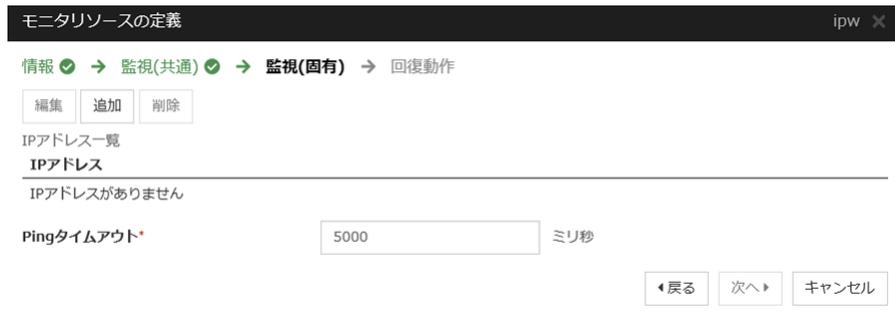
[IP アドレス一覧] で [追加] を選択し、3 で選択したサーバとは別のサーバの IP アドレスを設定します。
