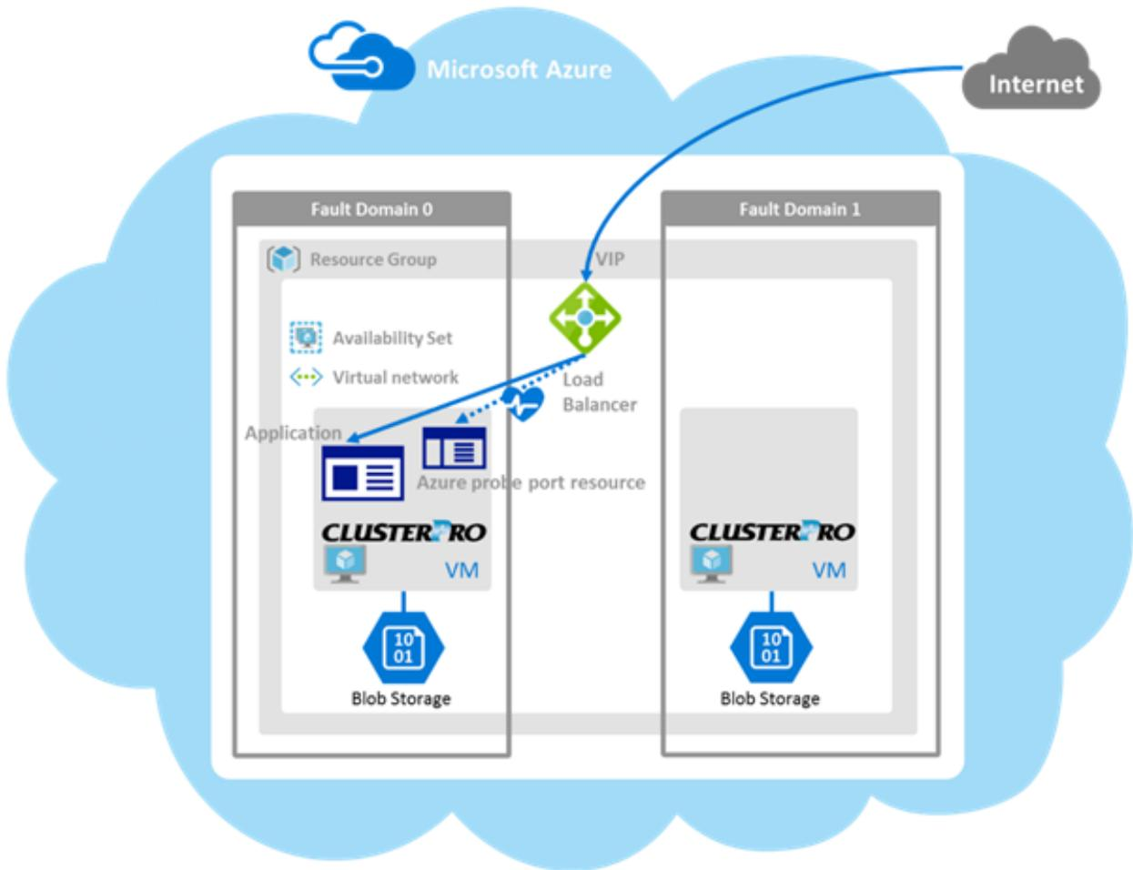
図 2.3 パブリックロードバランサーを使用した HA クラスタ
