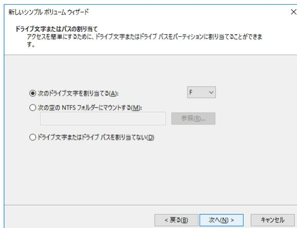
7. 次にデータパーティションを作成します。[ディスク 2] 上で右クリックし、[新しいシンプル ボリューム] を選択します。
