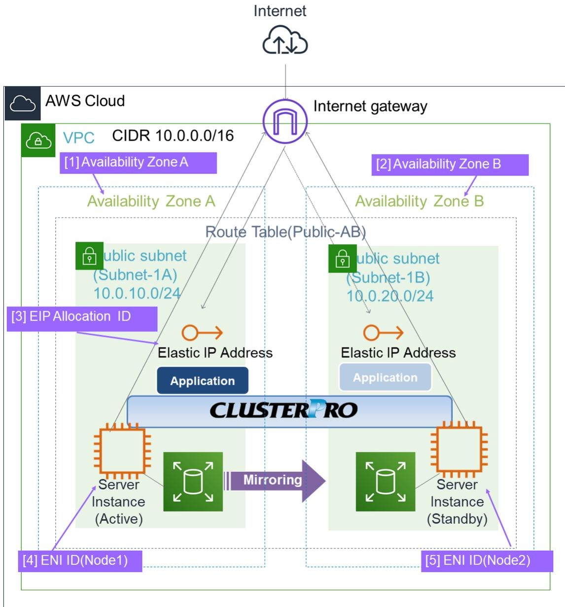
図 6.1 システム構成 EIP 制御による HA クラスタ
