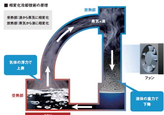
多段式高効率冷却技術とは受熱部を多段に構成し、それを最適化した独自の冷媒流路設計を行うことにより、ラック内での冷却ムラを防ぎ、高い受熱効率を実現する技術です。
