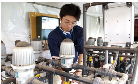
※給水用タンクなどの給水システムに設けた弁。バルブの開閉によって水の流量をコントロールし、作物に対する供給分量を調整する。
