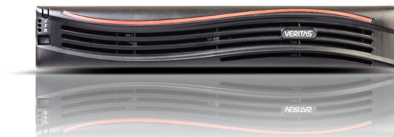
オプションの Veritas 2U12 49TB ストレージシェルフは、12 台の 6TB 7200 rpm SAS ハードディスクドライブを搭載する 2U12 ドライブエンクロージャです。ストレージシェルフで利用可能なストレージ容量は 49 TB です。各ディスクドライブには、ストレージシェルフの前面パネルからアクセスできます。ディスクドライブを RAID 6 に構成するために埋め込み RAID コントローラを使います。ドライブの 1 つはホットスペアとして予約されます。
