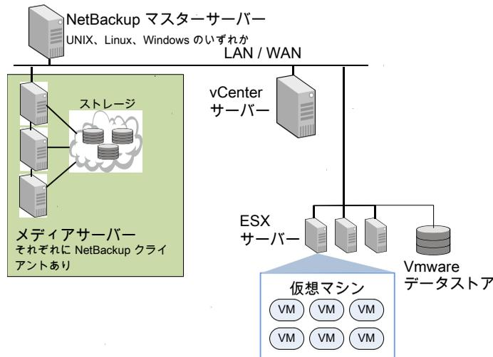
NetBackup の標準機能のストレージユニットグループとバックアップメディアサーバーの柔軟性を組み合わせることができます。メディアサーバーがアクセスできるストレージユニットを含むストレージユニットグループを作成します。すべてのメディアサーバーがバックアップホストとして動作できます。
