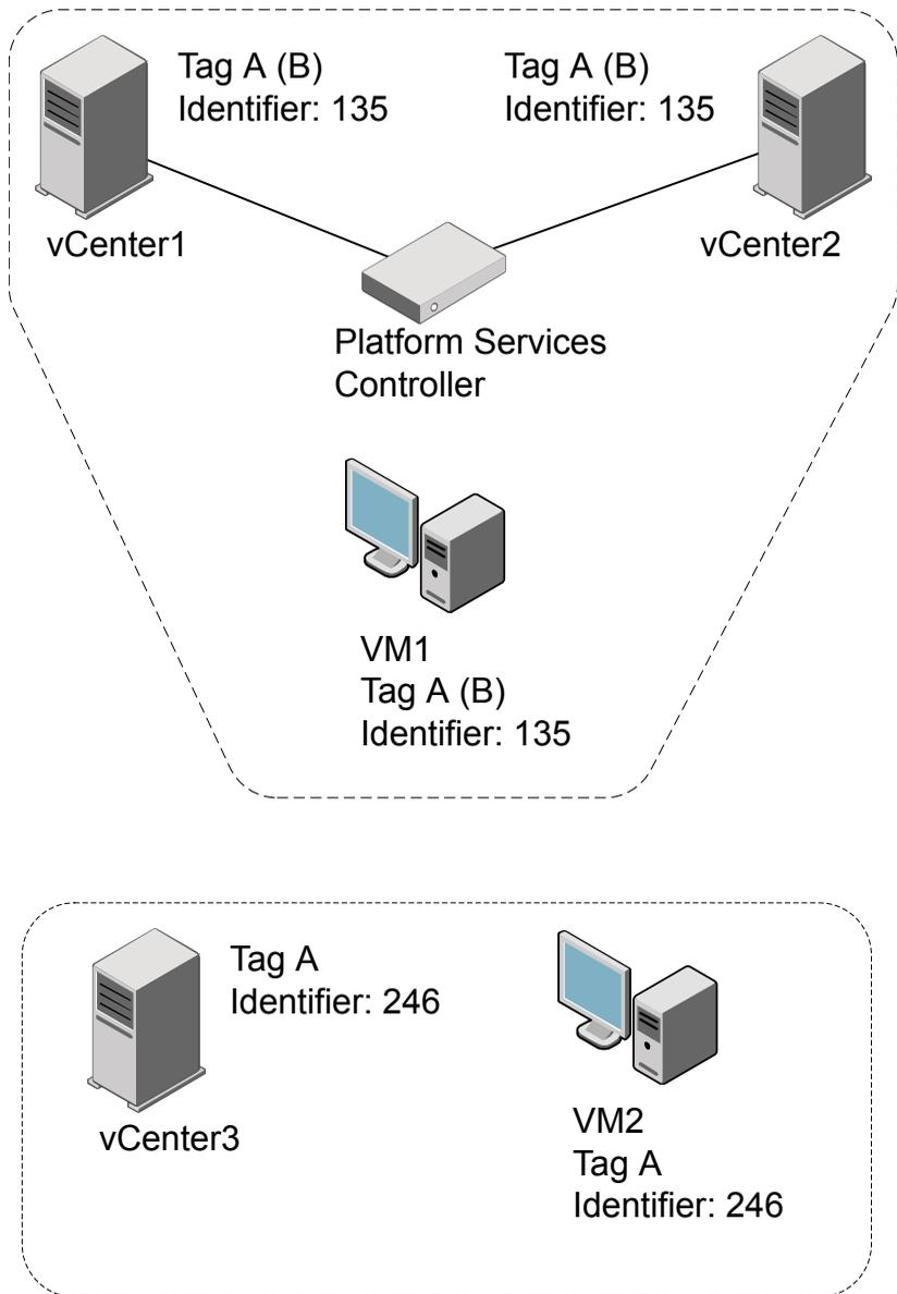
図 10-1 に、複数の vCenter Server、仮想マシン、およびタグで構成されるサンプル VMware 環境を示します。すべての仮想マシンのバックアップが NetBackup 状態コード 0 で成功していると仮定します。
