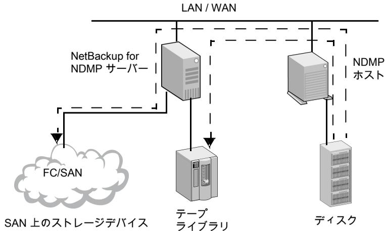
NetBackup サーバーに接続された Media Manager ストレージユニットへのバックアップデータは、NDMP ホストから NetBackup メディアサーバー上のドライブ、または SAN 上のドライブへ移動します。バックアップデータは、ローカルネットワークを介して送信されます。
