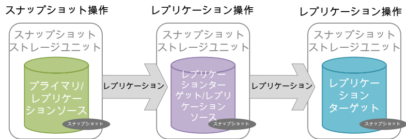
図 16-15 スナップショット操作と 2 つのレプリケーション操作を含む SLP
