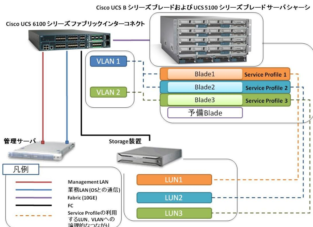
管理サーバ上の SSC は Cisco UCS 6100 シリーズファブリックインターノネットを介して、Cisco UCS ブレードおよびブレードシャーシ(筐体)に接続します。
