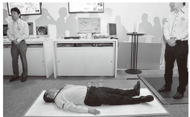
写真1 動きを検知するほかにも、人が倒れているとシート型センサが検知してアラートを出す「プレゼンスセンシング」
