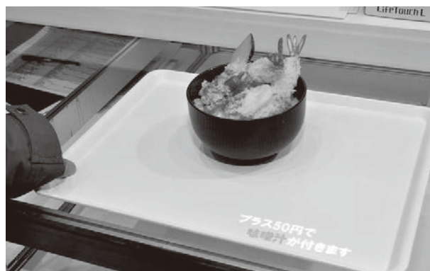
写真5 トレイの動きに追従して関連情報をトレイ上に投影する「アクティブプロジェクション」
