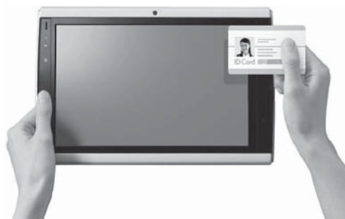
写真1 NFCモジュールの小型化により、タブレット前面での ICカード認証が可能に
