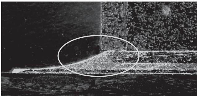
写真6 切断部のはんだフィレット形成状態
