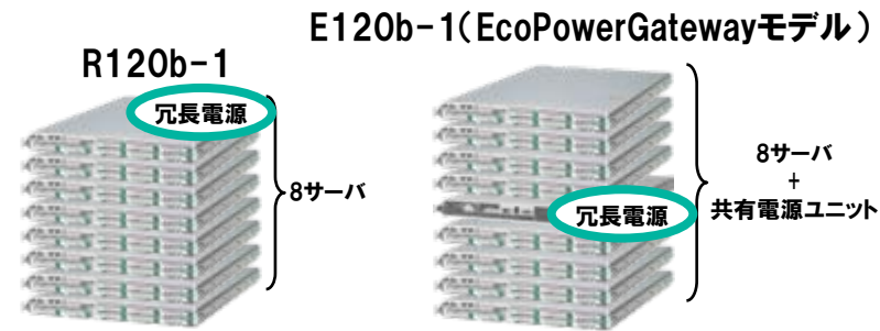
電源冗長構成での比較
