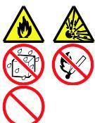
本機内部にはリチウムバッテリーやニッケル水素バッテリーもしくは、リチウムイオンバッテリーが取り付けられています(オプションデバイスの中にはリチウムバッテリーやニッケル水素バッテリーもしくは、リチウムイオンバッテリーを搭載したものもあります)。バッテリーを取り外さないでください。バッテリーは火を近づけたり、水に浸けたりすると爆発するおそれがあります。
