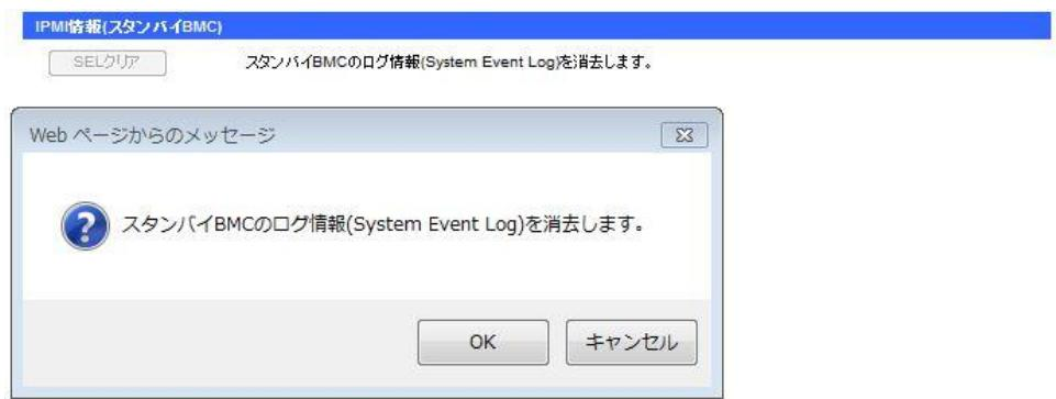
「SEL クリア」ボタンを押下すると、スタンバイ BMC 内に保存されている SEL のクリアを行います。「消去の確認」のポップアップメッセージが表示された後に「はい」ボタンを押下すると、SEL の消去が行われます。SEL の消去後は全削除実行を示す SEL だけが登録された状態になります。
