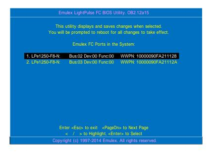
16> これで、Fibre Channel ストレージ装置へ OS をインストール開始する準備が整いました。<Esc>を押して、下記の確認メッセージに対して<Y>を押して本体装置を再起動し、OS のインストールを実施してください。
