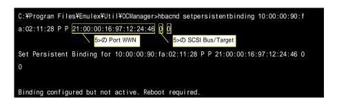
7> "hbacmd persistentbinding"をSource "C"で設定をおこなった本製品に対して実行して、正しく設定されていることを確認します。
