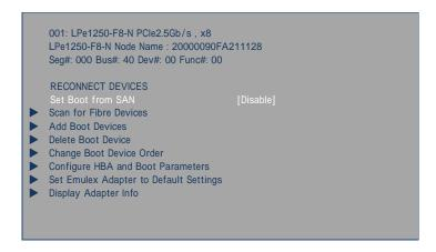
13> 選択メニューが表示されますので"Enable"を選択して<Enter>を押します。
