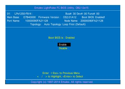
15> <Esc>を押して初期メニュー画面に戻ります。OS インストールをおこなう Fibre Channel ストレージ装置が接続されている本製品が他にもある場合は 4>以降と同様の手順で、Boot デバイス登録と Boot BIOS の Enable 設定をおこないます。
