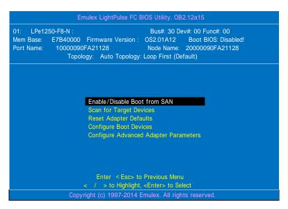
5> "Reset Adapter Defaults"を選択し<Enter>を押します。下記の確認メッセージが表示されますので<Y>を押してポートの設定を初期状態に戻します。
