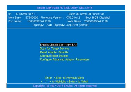
13> "Enable/Disable Boot from SAN"を選択し、現在の BIOS 設定状態と設定変更の画面を表示させます。
