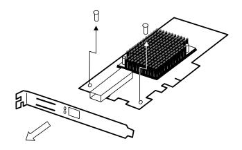
3. ロープロファイルブラケットを本製品に取り付け、ネジ(2本)で固定します。
