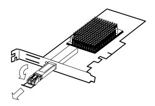
4. 本体装置のユーザーズガイドに従って PCI スロットへ本製品を取り付けます。
