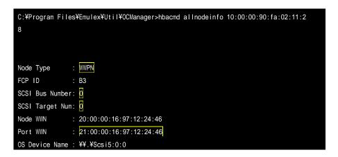
12> 同様の手順で対象となる全ての本製品でFibre Channelストレージ装置のWWPNアドレスがNode Type "WWPN"で正しく認識できていることを確認します。
