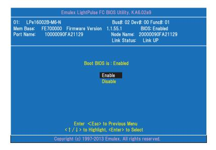
15> 〈Esc〉を押して初期メニュー画面に戻ります。OS インストールをおこなう Fibre Channel ストレージ装置が接続されている本製品・ポートが他にもある場合は 4>以降と同様の手順で、Boot デバイス登録と Boot BIOSの Enable 設定をおこないます。
