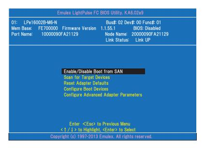
5〉 "Reset Adapter Defaults"を選択しくEnter>を押します。下記の確認メッセージが表示されますのでくY>を押してポートの設定を初期状態に戻します。
