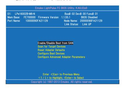
13> "Enable/Disable Boot from SAN"を選択し、現在の BIOS 設定状態と設定変更の画面が表示させます。
