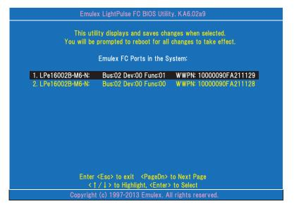
16> これで、Fibre Channel ストレージ装置へ OS をインストール開始する準備が整いました。〈Esc〉を押して、下記の確認メッセージに対して〈Y〉を押して本体装置を再起動し、OS のインストールを実施して〈ださい。
