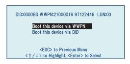
11> "Boot this device via WWPN"を選択して<Enter>を押します。Boot デバイスの設定画面が再度表示されますのでリストの一番上にある"Primary Boot"のエントリが「Used」となっていることを確認します。
