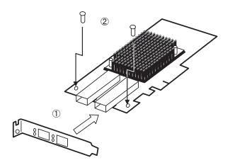
4. 1. で取り外した SFP+モジュール(2式)を取り付けます。
