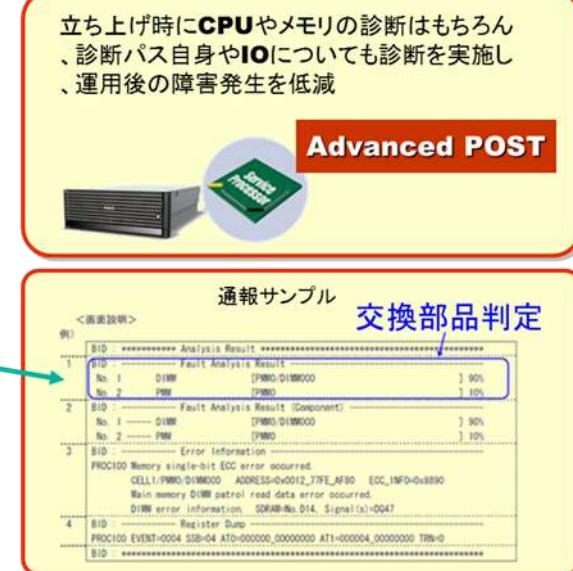
2 一般的な IA サーバでは、サービスプロセッサ、クロック、または、基本 I/O(\*) の障害時に、長時間システムがダウンすることがあります。 NX7700x シリーズ(一部モデル)では、CPU, メモリ, I/O カード等を除いた冗長リソースを用意できない部位に予備リソースを用意。リブート不可となる SPOF を排除します。
