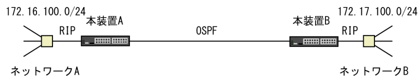
図 7-3 異なるネットワークアドレスのサブネット間の接続
