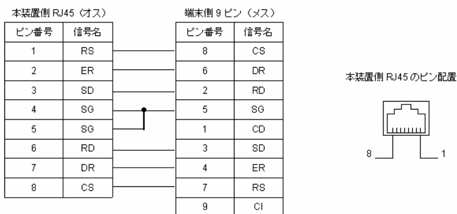
図 3-1 運用端末接続ケーブル
