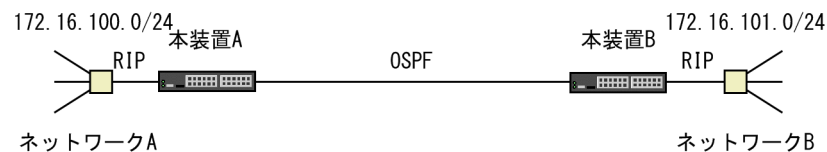
図 8-5 サブネット間の接続の例
