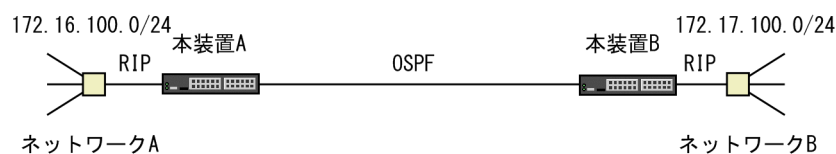
図 8-3 異なるネットワークアドレスのサブネット間の接続
