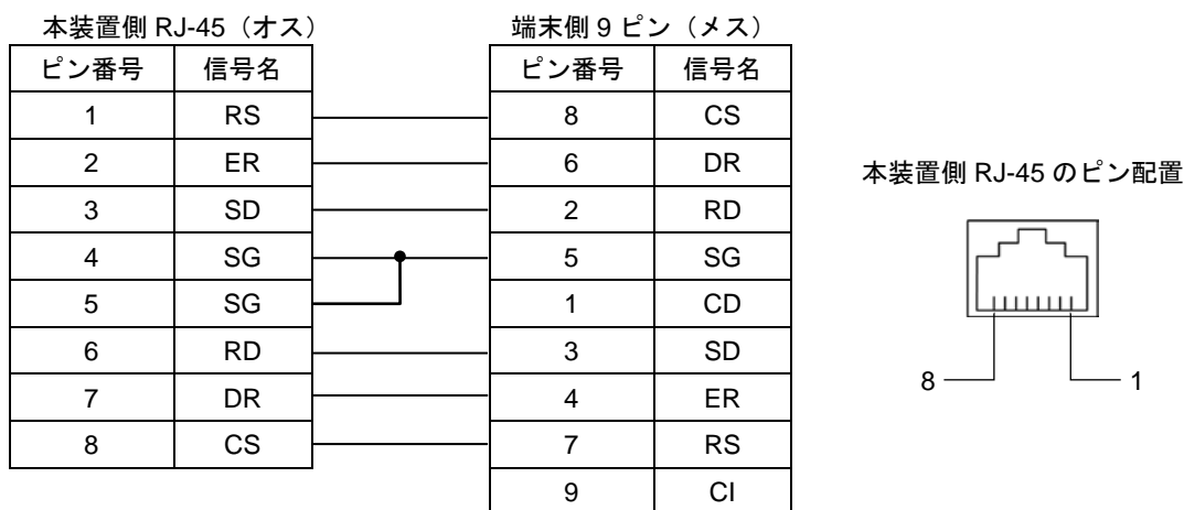
図 1-2 運用端末接続ケーブル
