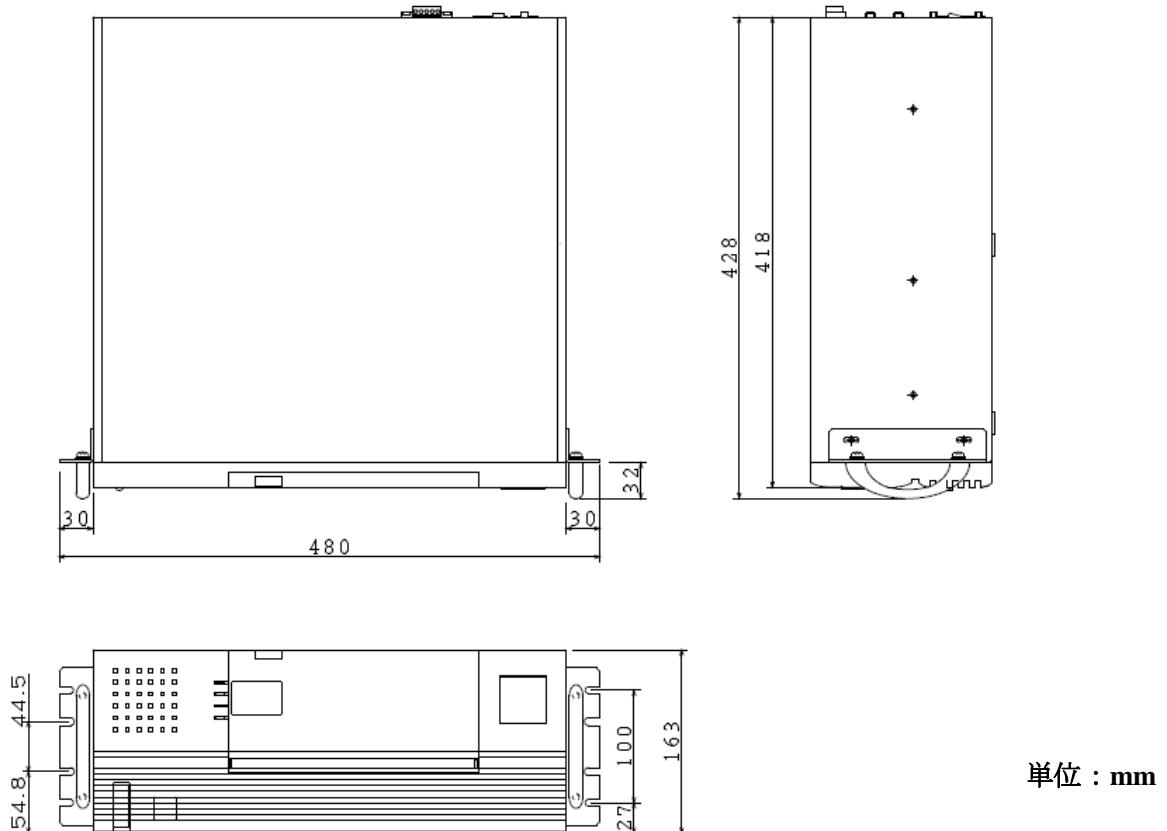
※19インチラック取付金具(FC-RK002R)の取付位置は、上下に4.5mm変更することができます。
