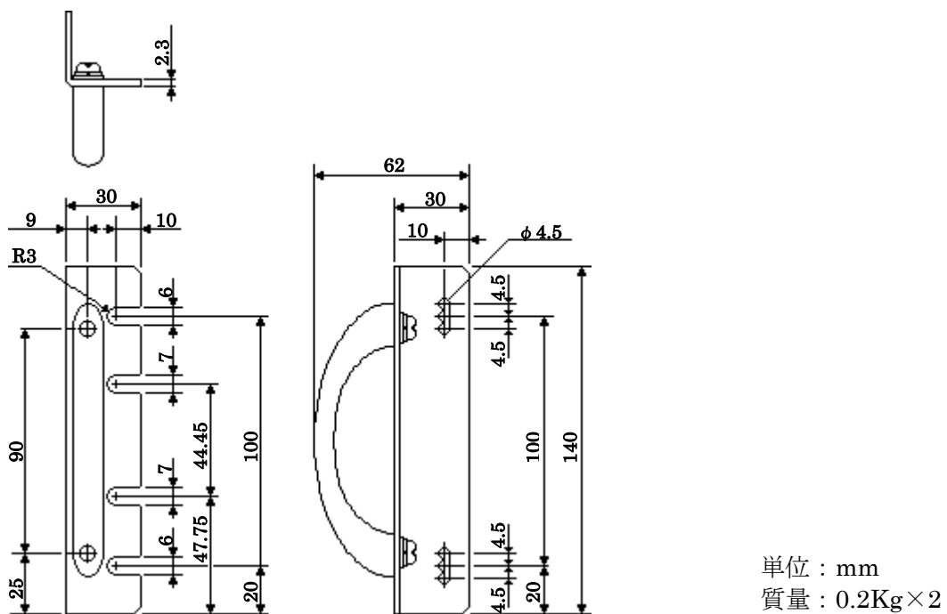
※19インチラック取付金具(FC-RK002R)の取付位置は、上下に4.5mm変更することができます。
