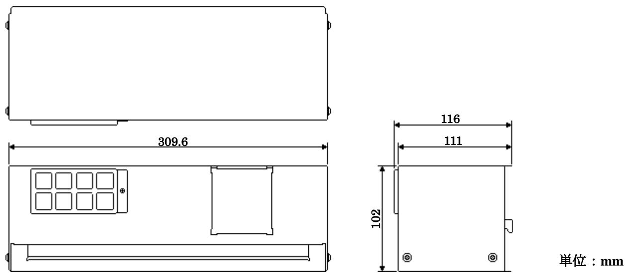
◆ 本体固定金具(FC-RK004)装着 縦置き設置時 外形寸法図
