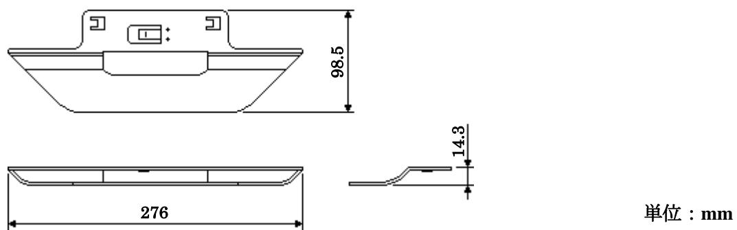
◆ 防塵フィルタ(FC-FL007) 装着時 外形寸法図
