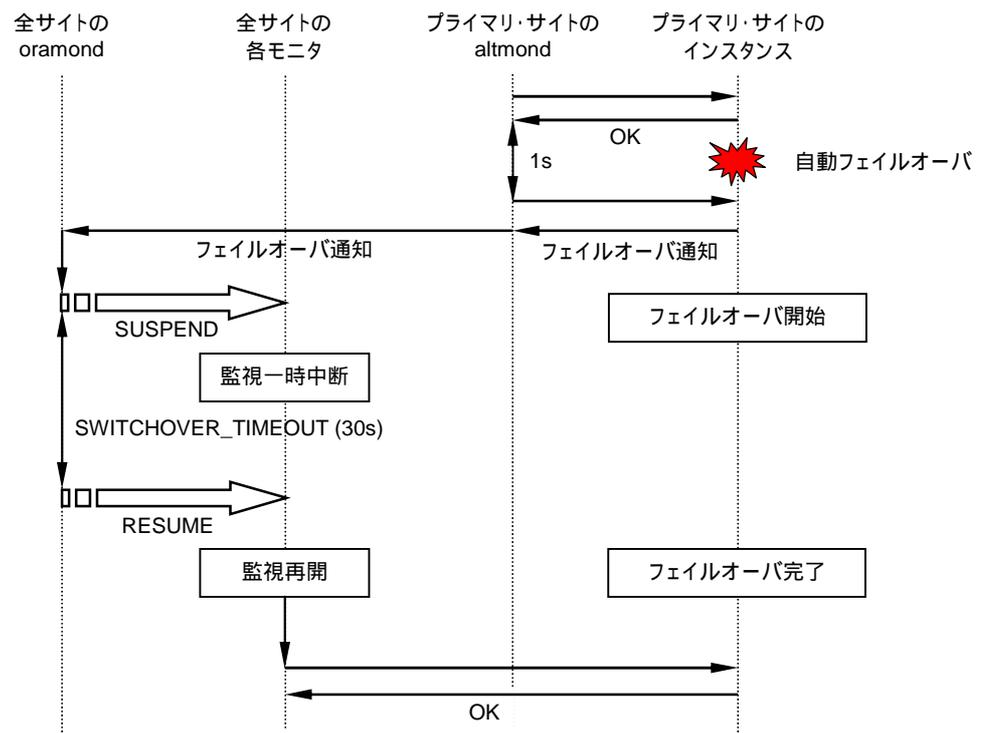
図 4-46 Oracle Data Guard Broker による自動フェイルオーバー時の監視動作
