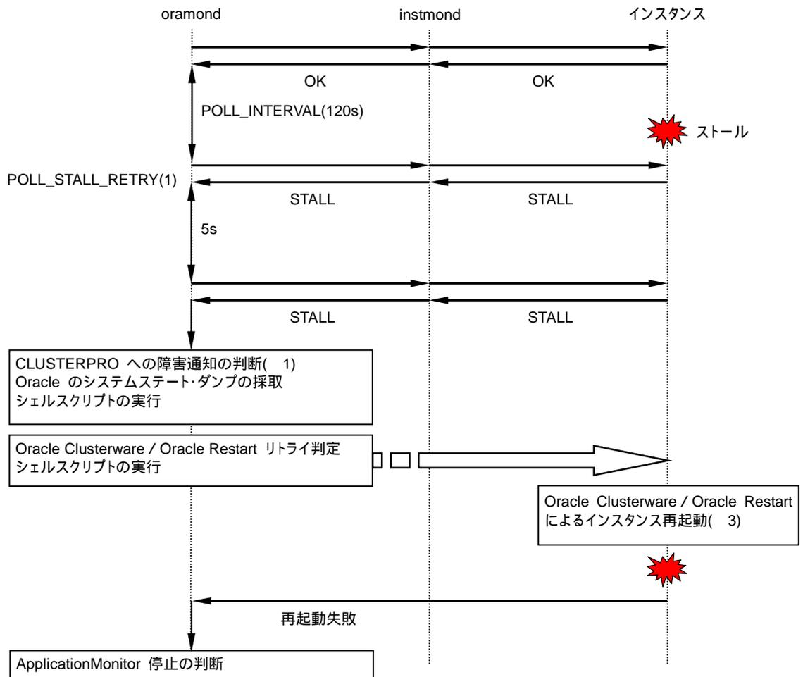
図 4-6 Oracle バックグラウンドプロセスのストール時の動作
