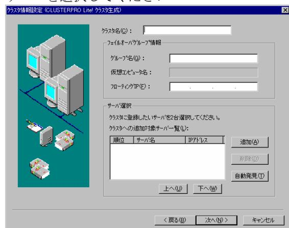
1. サーバ選択グループの「追加」のボタンを押すとサーバ選択ダイアログが表示されます。
